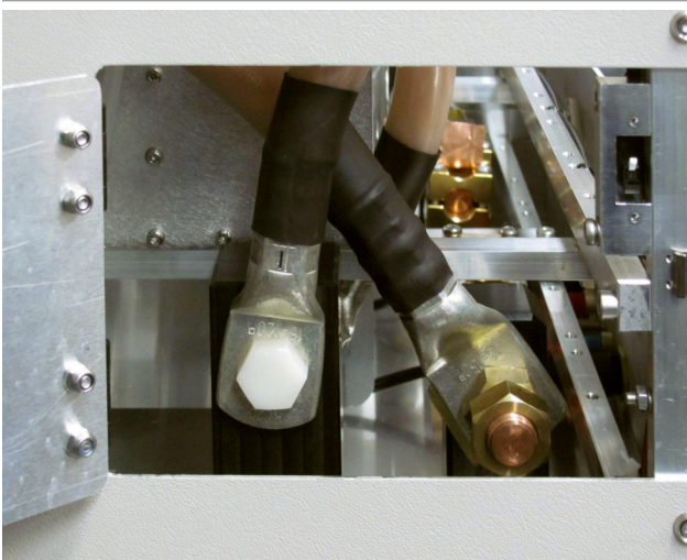
Abb. 11. Die Batterienachbildung in LISN Konfiguration: 1 \mu H pro Pfad. Die Kurzschlussbrücke befindet sich auf der isolierten Halterung in Parkposition, erkennbar an der Nylonschraube. Fig. 11. LISN configuration: 1 \mu H per path. The short-circuit bridge is located on an insulated holder in „parking position“ (polyamide screw).
